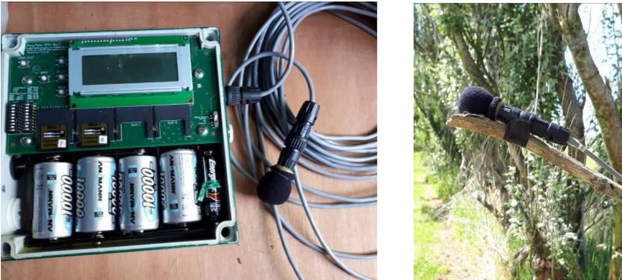
Figure 31- Matériel utilisé pour la détection des chiroptères (photo A. Le Houédec)
